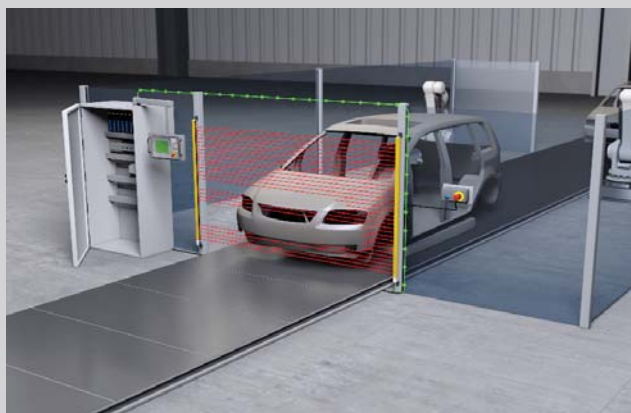
Afbeelding 1: Procesgestuurde toegangsbeveiliging met Smart Process Gating (SPG)
