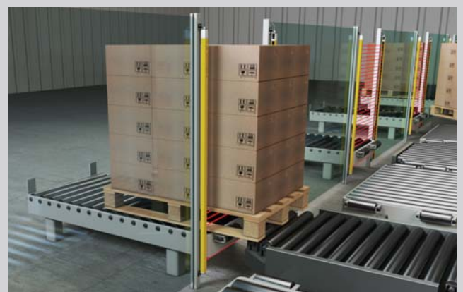
Afbeelding 6: Voorbeeld van een toepassing voor bedrijfsmodus met transportsnelheid tot maximaal 0,6 m/s
